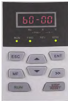
Fig. 4-9 First-tier display of parameter
